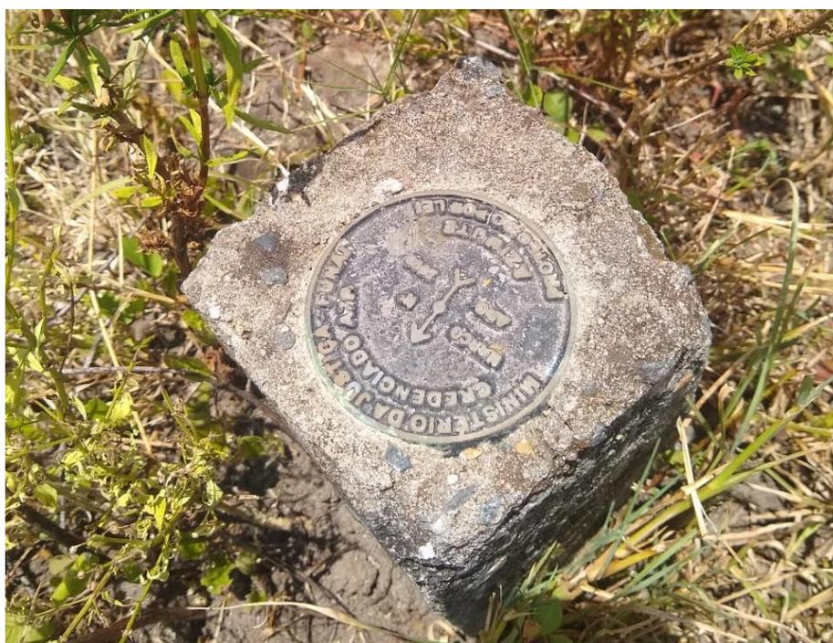
Fotografia 27: Marco Testemunhal que confirma que ocorreu ali uma medição. O marco testemunha, portanto, é temporal e de localização. Foto/Fonte: Kairo Khrystyan de Souza Barbosa. Data: 19/04 2021.
